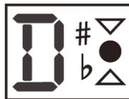
TUNER スイッチを踏み込むことでクロマチックチューナーが起動し、入力信号をミュート、チューナーウィンドウの LED が点灯します。緑色のランプが点灯している場合は、チューニングが合っています。赤い矢印が出た場合は
