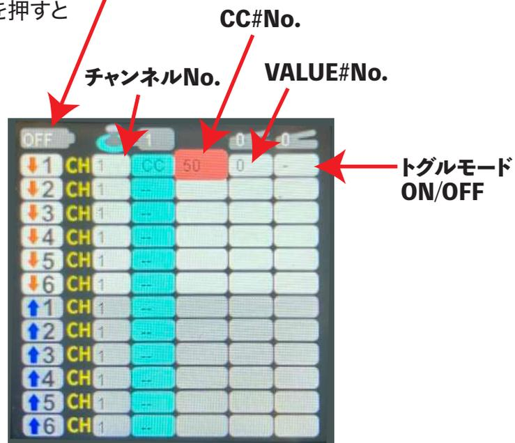
その他の項目も同じ手順で設定します、チャンネルナンバーはエフェクター側のチャンネルナンバーに合わせてください。VALUEナンバーは必要な場合のみ指定のVALUEナンバーに設定してください。トグルモードも必要な場合は「T」に設定してください。
