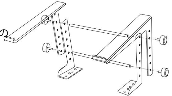
3. フラットフット・バーを4組のネジAで下側サポート板
