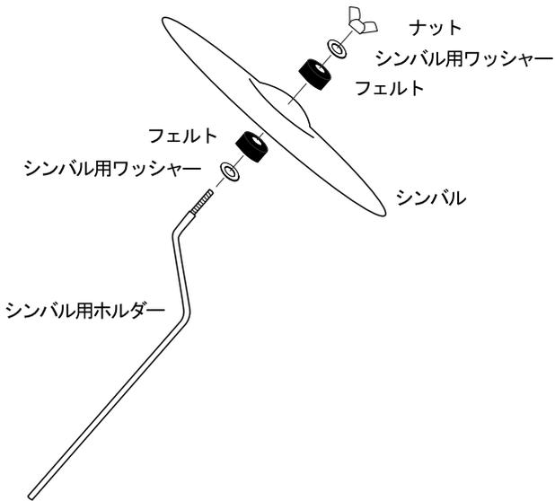
シンバルホルダーから、ナット、ワッシャー、フェルトを外します。
