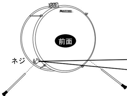
バスドラムがぐらつかない様に、足の突起を取り付け部の穴に合わせて差し込み、バスドラムの足をネジで固定します。
