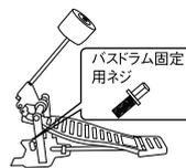
左図の様にバスドラムのフープにある固定用パーツの下にペダルを差し込みます。
