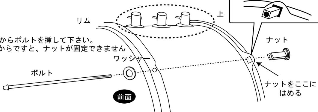
●4ヶ所あるリムの穴を合わせてボルトとナットで固定して下さい。
