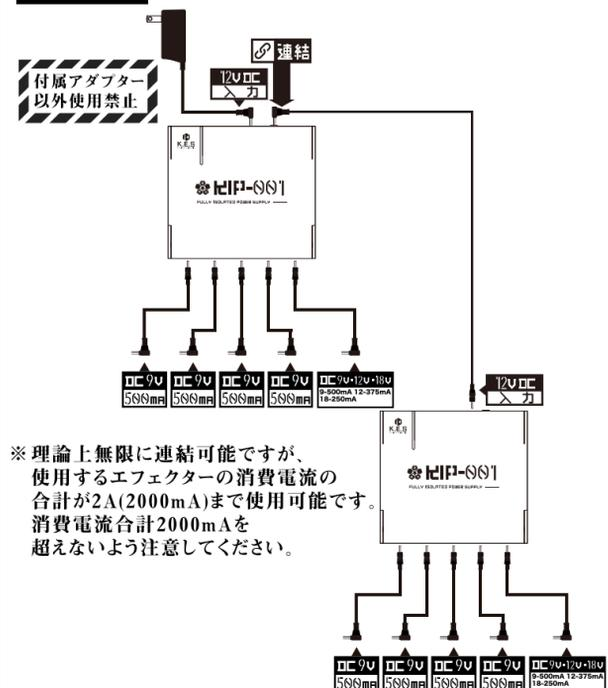
※理論上無限に連結可能ですが、使用するエフェクターの消費電流の合計が2A(2000mA)まで使用可能です。消費電流合計2000mAを超えないよう注意してください。
