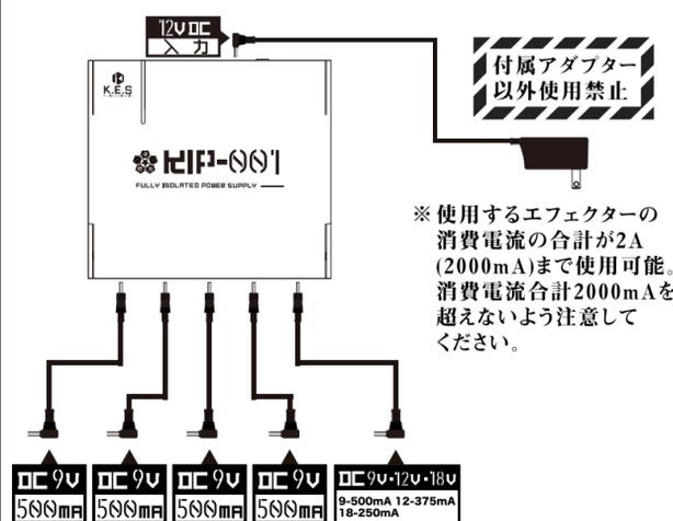
※使用するエフェクターの消費電流の合計が2A (2000mA)まで使用可能。消費電流合計2000mAを超えないよう注意してください。
