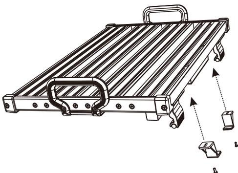
固定ブロックとブロック用ねじ、T型金具を組み
