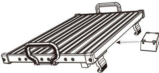
電源固定用の金具をアルミフレームに取り付け、
