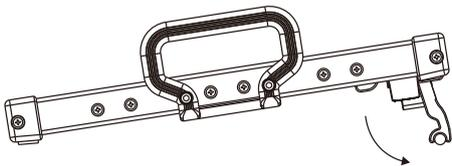
ペダルボードの底に電源ユニットを配置します。
