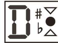
TUNER スイッチを踏み込むことでクロマチックチューナーが起動し、入力信号をミュート、チューナーウィンドウの LED が点灯します。緑色のランプが点灯している場合は、チューニングが合っています。赤い矢印が出た場合は上向き矢印 = フラットしています。ピッチを上げてください。下向き矢印 = シャープしています。ピッチを下げてください。
