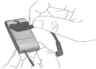
(3)マジックカーペットのクリアプラスチックを剥がして楽器に取り付けてください。
