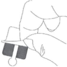
(2)マジックカーペットをiSoloトランスミッター裏面の四角い部分に取り付けて約5秒間押しつけてください。
