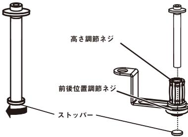
⚠ 必ずストッパーを外し、高さ調節部の下から前後位置調節パーツに通してください。高さ調節部の上部からは通りません。
